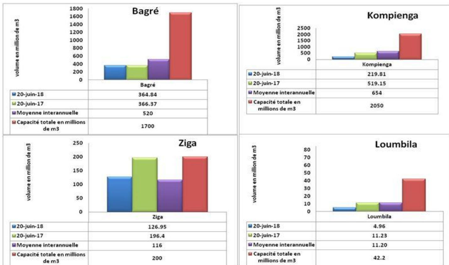
Figure 4 : Situation de remplissage au 20 juin 2018, comparaison avec la situation de 2017, la moyenne inter-annuelle et la capacité nominale des barrages.
